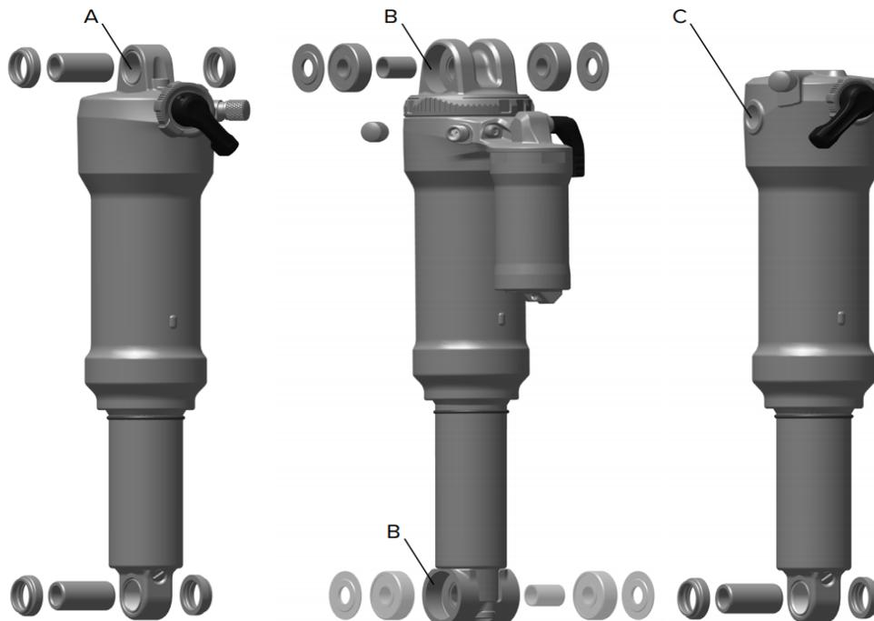
Bild 1 Eyelet-Varianten: Quelle: sram.com
